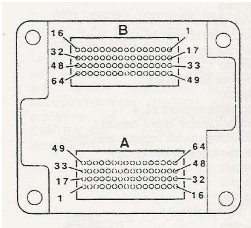
Prima di eseguire qualsiasi operazione sulla centralina si deve collegare **Il pin 20 del connettore A lato etichetta di identificazione della centralina, a massa di potenza.**
