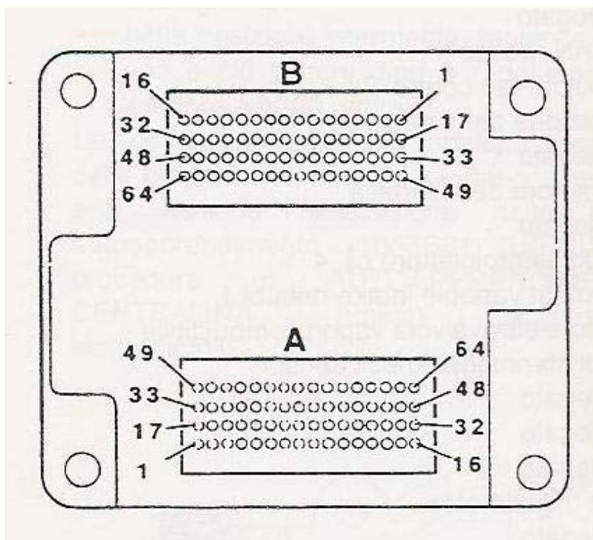
Prima di eseguire qualsiasi operazione sulla centralina si deve collegare **Il pin 20** del connettore **B** lato opposto etichetta di indetificazione della centralina, a massa di potenza.
